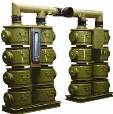
Предназначена для регенерации воздуха по кислороду и двуокиси углерода в помещениях убежищ, эксплуатируется при температуре газовоздушного потока от +10 до +31 °C и относительной влажности 60-90%. Установка состоит из 16 патронов П-10 и монтажных деталей к ним.
