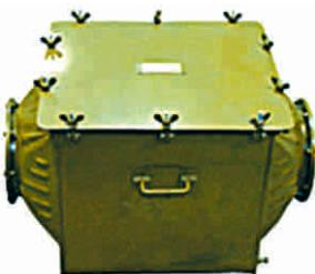
Предназначен для очистки воздуха от грубодисперсных аэрозолей, входит в состав комплектов ФВК-1 и ФВК-2. Эксплуатируется в наземных и подземных защитных сооружениях при температуре воздуха от -50 до +50 °C и относительной влажности воздуха 95% при исключении попадания в предфильтр капельно-жидкой влаги.
