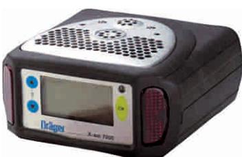
Новаторское решение для одновременного и непрерывного обнаружения до пяти газов. Прибор может быть оснащен тремя электрохимическими сенсорами на токсичные газы и кислород, двумя термокатализитическими или инфракрасными сенсорами на взрывоопасные газы и CO<sub>2</sub>. Большой графический дисплей отображает измеренную концентрацию до 5 газов одновременно.
