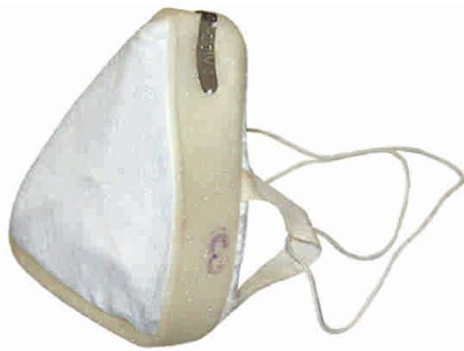
**Назначение.** Полумаска предназначена для защиты органов дыхания от различных аэрозолей при объемном содержании свободного кислорода в воздухе не менее 17%, концентрации аэрозолей не более 200 мг/м<sup>3</sup> и положительной температуре не более плюс 50°C.
