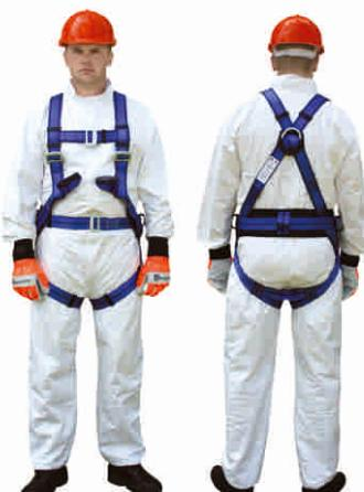
Предназначен для обеспечения безопасности при работе на высоте и на опорах линий электропередачи как удерживающая и страховочная привязь, а также для работы в колодцах, траншеях и других емкостях и резервуарах, когда может возникнуть необходимость срочной эвакуации работающего на поверхность.
