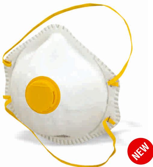
**Назначение.** Полумаска предназначена для защиты органов дыхания от вредных аэрозолей при объемном содержании свободного кислорода в воздухе не менее 17 %, концентрации аэрозолей не более 200 мг/м<sup>3</sup>, при температуре окружающей среды от 0 до плюс 40 °C.
