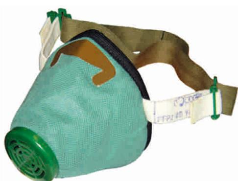
**Назначение.** Полумаска предназначена для защиты органов дыхания от различных аэрозолей при объемном содержании свободного кислорода в воздухе не менее 17%, концентрации аэрозолей не более 200 мг/м<sup>3</sup>, при температуре воздуха от минус 40 до плюс 40°С.
