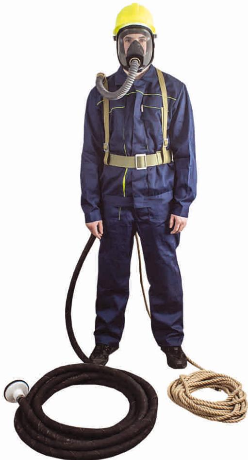
**Назначение.** Противогаз ПШ-1, представляющий собой безнарный одноканальный изолирующий дыхательный аппарат, предназначен для защиты органов дыхания, глаз и лица человека при выполнении работ в условиях объемного содержания кислорода в воздухе менее 17%, а также при содержании вредных веществ неизвестного состава и концентраций или при объемном содержании вредных веществ в воздухе более 0,5%.
