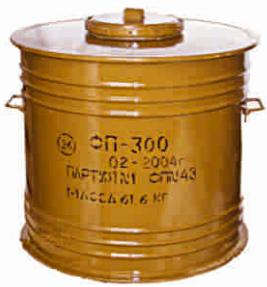
Предназначен для очистки воздуха, подаваемого в убежище или защитное сооружение, от отправляющих веществ, радиоактивной пыли, бактериальных аэрозолей, ядовитых и нейтральных дымов. Эксплуатируется при температуре воздуха от -50 до +50 °C, относительной влажности до 95% при условии исключения попадания в фильтр капельно-жидкой влаги.
